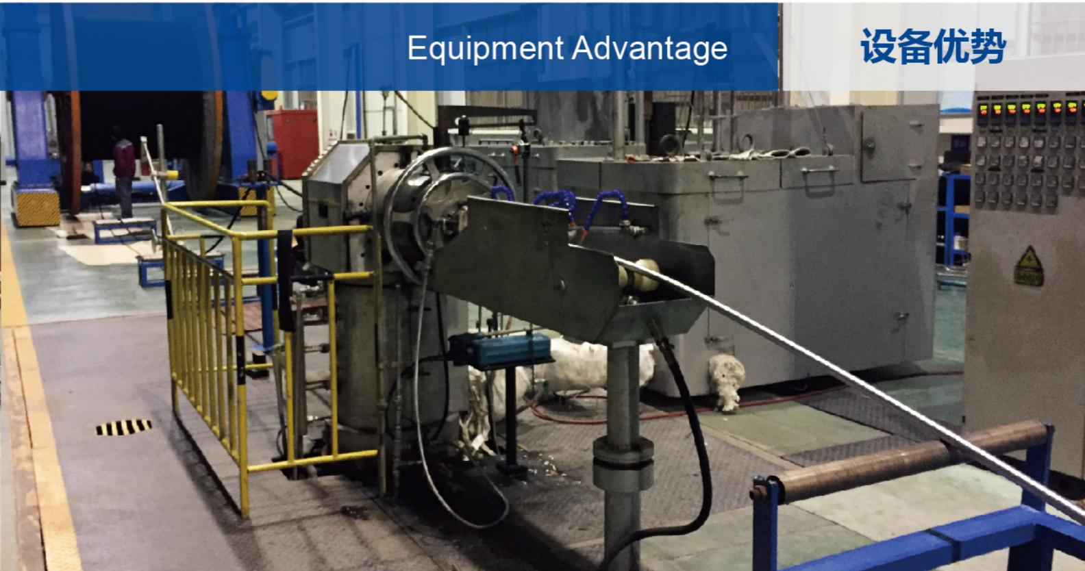
**220kV CCV 悬链式交联生产线——芬兰 Mallefer 制造**
