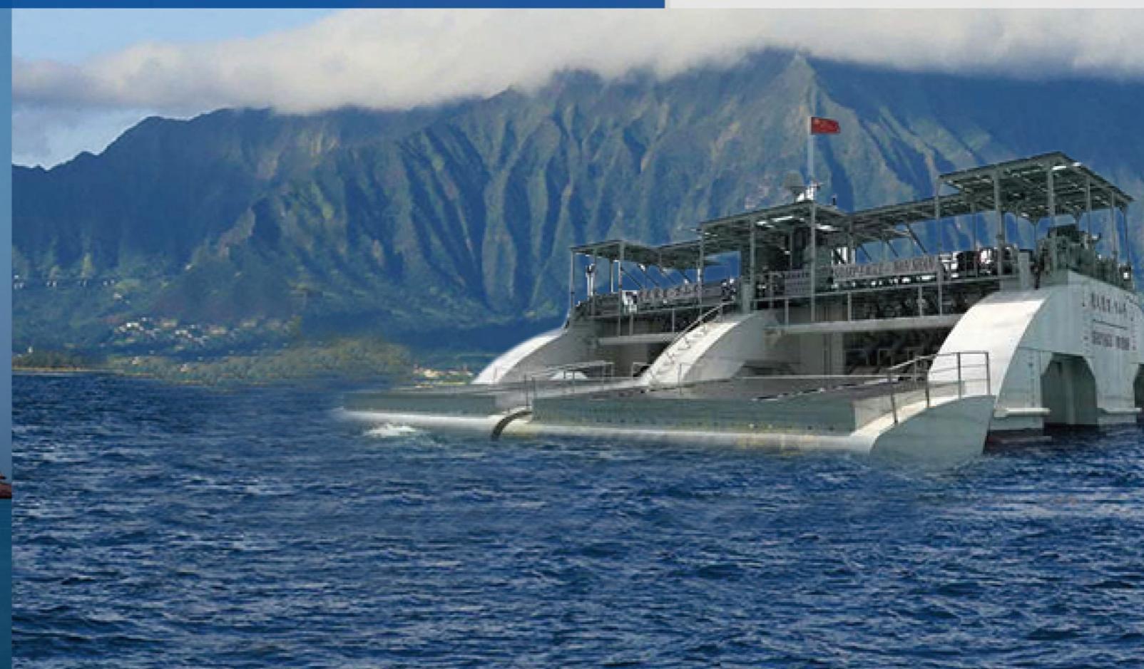
随着海洋新资源的开发利用，海洋能发电技术以其独特优势和战略地位吸引了人们的注意，海洋波浪蕴藏着巨大的能量。中国科学院广州能源研究所在国家海洋可再生能源专项和中国科学院A类战略先导科技专项支持下，在广东珠海万山岛研建一座大型漂浮式波浪能发电装置。2016年山东万达海缆有限公司为本工程提供一条直流海缆及防弯器、锚固装置等配件，使得平台在海上输出DC24V、AC220V、AC380V的标准电力通过海底电缆送电上岸。
